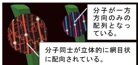
ヤーンの構造（左：実証対象製品、右：一般的な人工芝）
