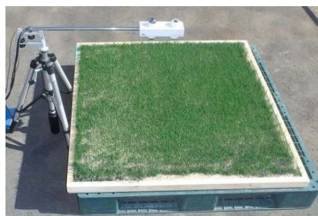
図5-1 日射反射率の屋外試験方法の概要（上）と試験実施状況写真（下）
