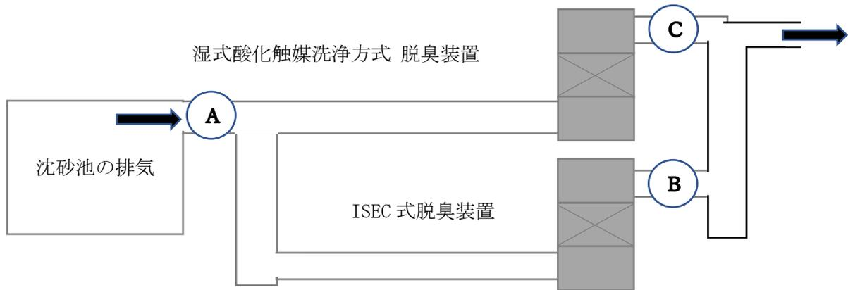
(A 点：脱臭装置 入口、B 点：ISEC 式脱臭装置 出口、C 点：湿式酸化触媒洗浄方式 脱臭装置出口)
