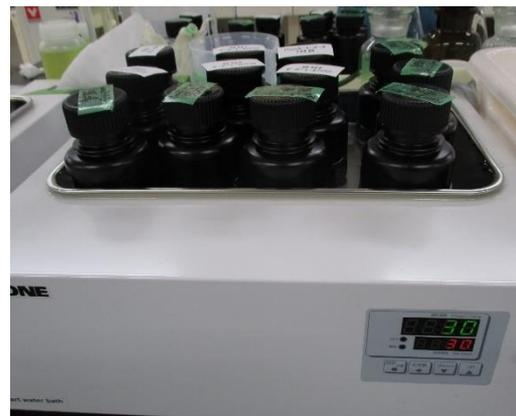
図5-4 ウォーターバス内での試料の保管の様子
