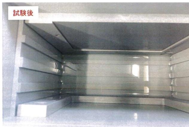
図6-17 試験後の電極槽内の外観
