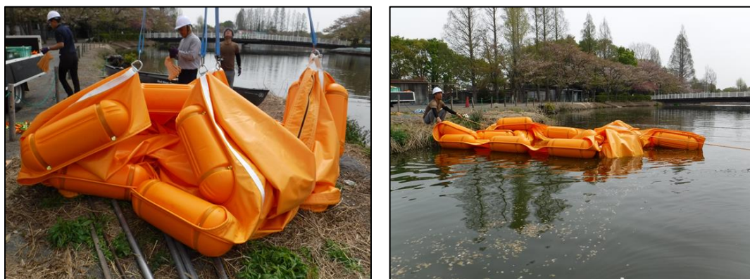
図 3-4 隔離水界の設置風景
