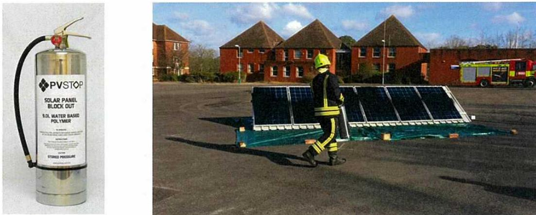
図2-1 実証対象製品の外観（左）と太陽光パネルへの噴射の様子（右）
