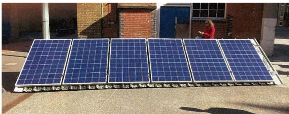
図5-1 試験に使われた太陽光発電アレー（モジュール6台）
