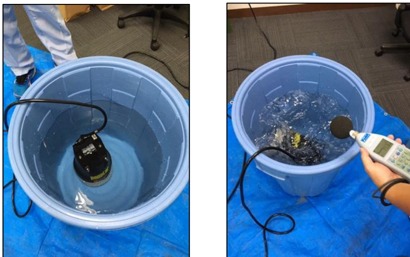
水中ポンプ方向からの騒音測定
