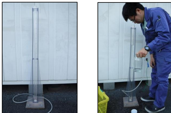
図 4-2 透視度計（写真左）と透視度測定の様子（写真右）
