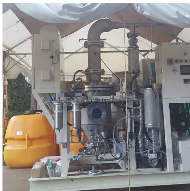
写真 17 高性能オゾン処理装置
