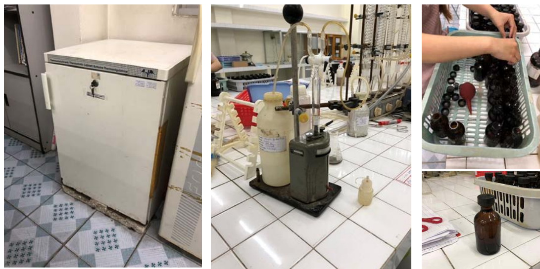
図 BOD 測定（左：使用した恒温器、中：滴定装置、右：測定作業と培養瓶）
