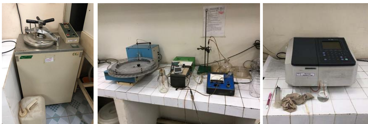
図 全窒素、全リン測定（左：オートクレーブ、中：分析装置の外観、右：分光光度計）
