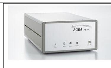
ガスクロマトグラフのキャリアガスには大気を活性炭により精製して使用することにより、測定精度の向上を図るとともに、全体を小型、軽量化した分析装置となっている。このため、現場でのオンサイト測定も可能である。試料採取方法としては、シリンジによる手動注入方式(自動測定開始機能付)あるいは、連続自動測定方式の仕様がある。実証試験は手動注入方式にて実施した。
