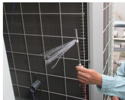
室外機周囲の風向風速の簡易測定の様子
