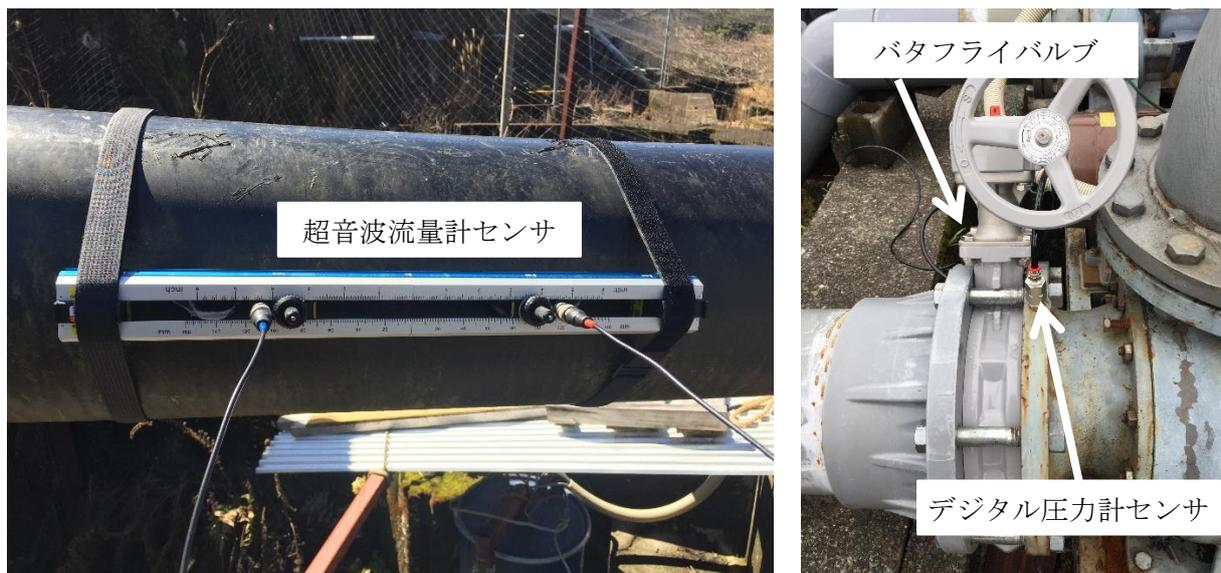
写真 4-1 流量計と圧力計の設置
