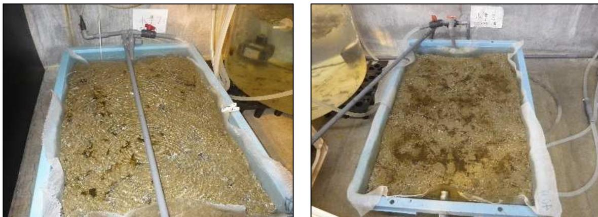
図 3-7 1ヶ月経過後の試験状況(左図：無施用区，右図：セラクリーン区)
