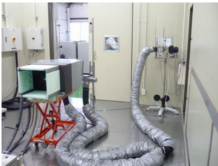
写真 4-5 実証対象技術のヒートポンプと二次側吸込み空気温度の測定装置
