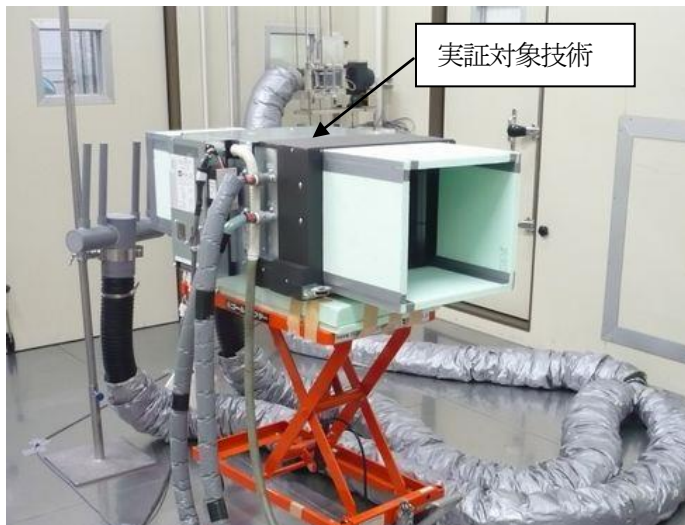
写真 4-4 実証対象技術のヒートポンプと二次側吸込み空気温度の測定装置
