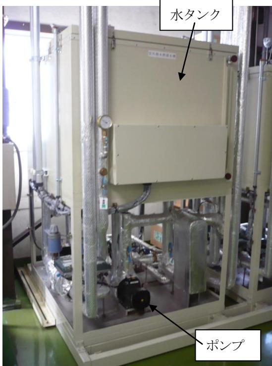
写真 4-4 一次側熱媒（水）の定温設定用の水タンクとポンプ、流量計（試験室外に設置）
