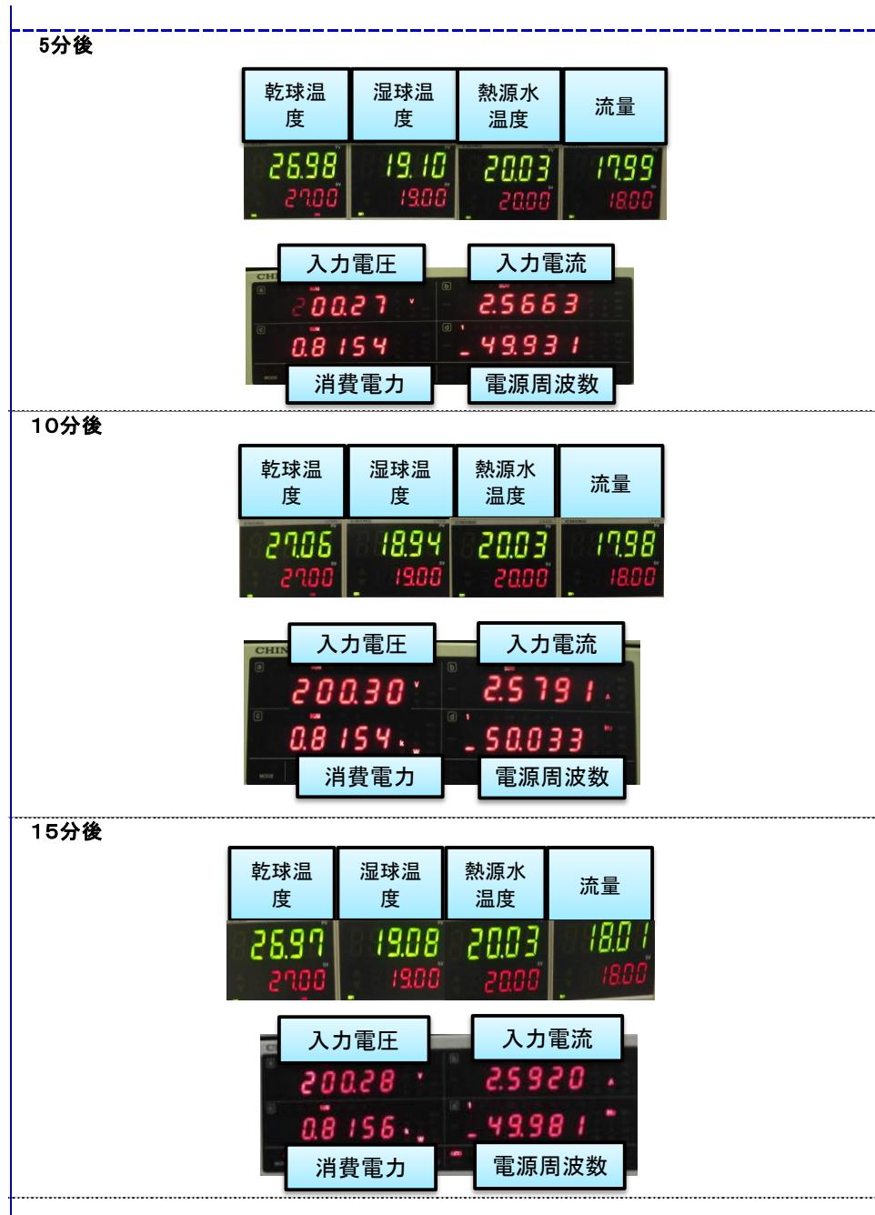
図 6-1 測定時の計測器の表示例（冷房温度条件 1 の例）
