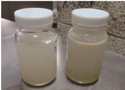
最終処理水（左：浮上物無し） 粗目 SS ネット流入水（右：浮上物有）
