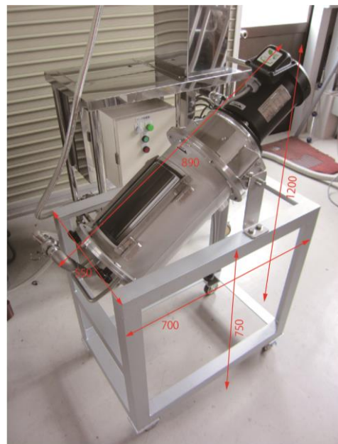
メカニカル SS クリーナー W550 mm × D700 mm × H750~1,200 mm
