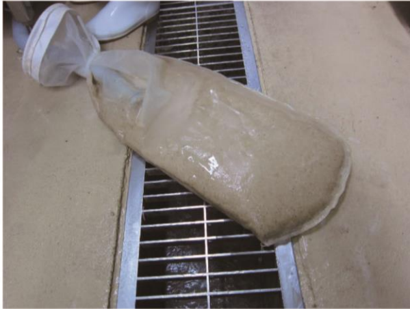
厨房残渣物（油分回収部のドレン排水をネット（ 400\mu\text{m} ）を使用して回収）
