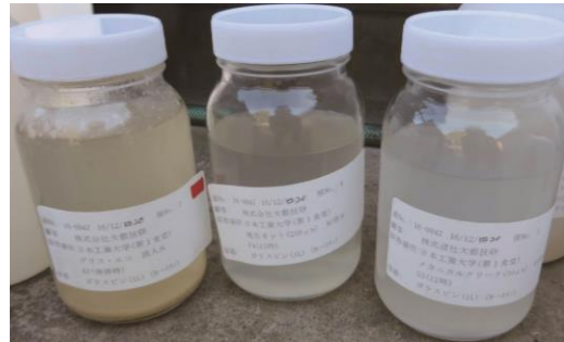
最終処理水（右：容器内油分付着無し） 粗目 SS ネット処理水（中：容器内油分付着無し） グリス ECO 流入水（左：容器内油分付着有）
