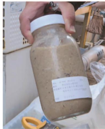
粗目 SS ネットによる SS 回収残渣物（使用ネット 250\mu\text{m} ）
