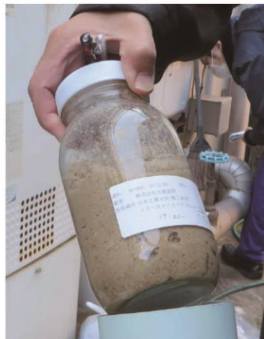
メカニカル SS クリーナーによる SS 回収残渣物（使用ネット 30\mu\text{m} ）
