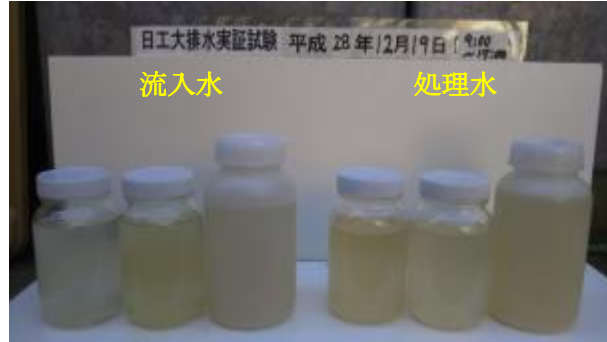
図 6-4 グリスECOの流入水・処理水（12月19日の試料）
