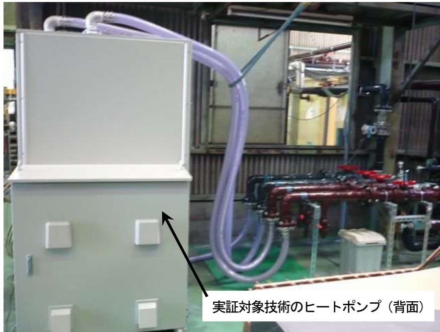
写真 4-1 実証試験中の実証対象技術のヒートポンプと試験設備
