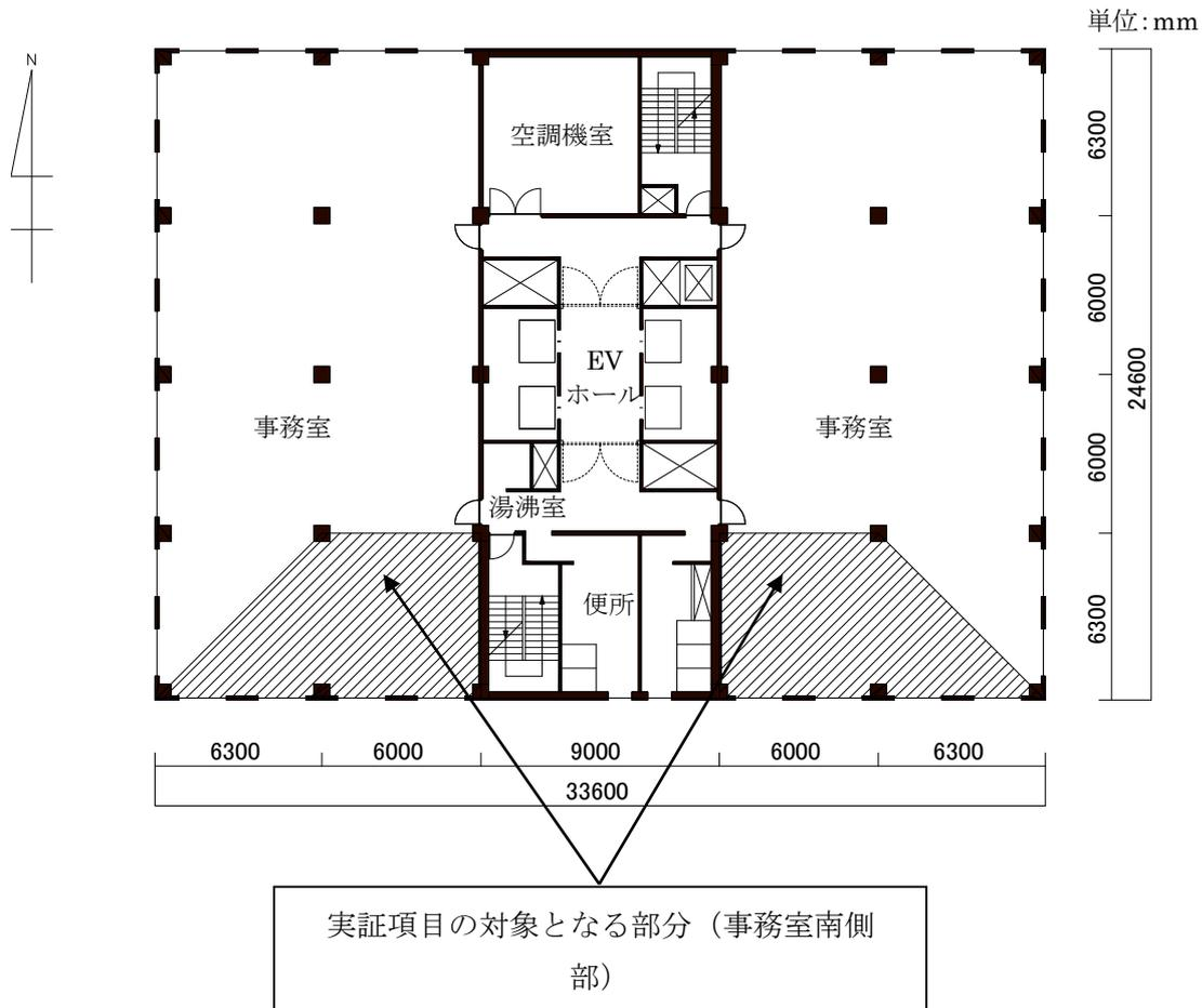
図 4-2 計算用オフィスモデル（平面図）
