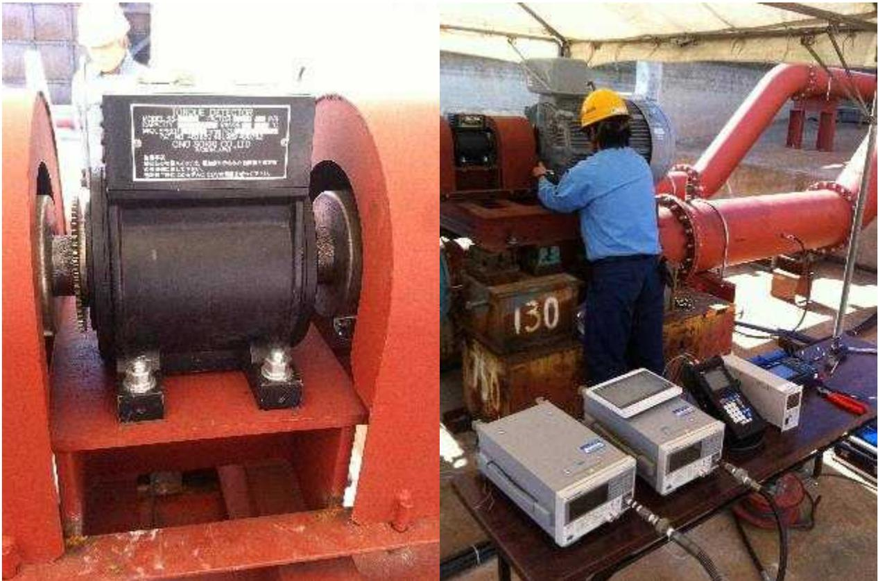
写真 8-1 軸動力測定の実験確認
