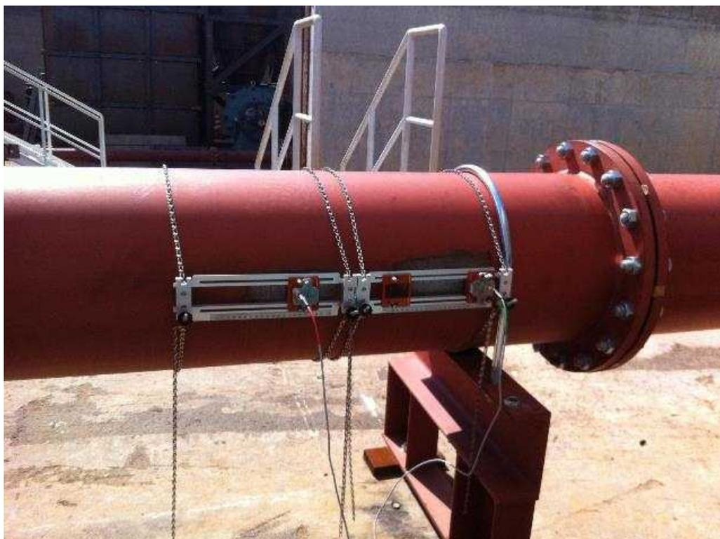
写真 3-2 流量測定点の様子
