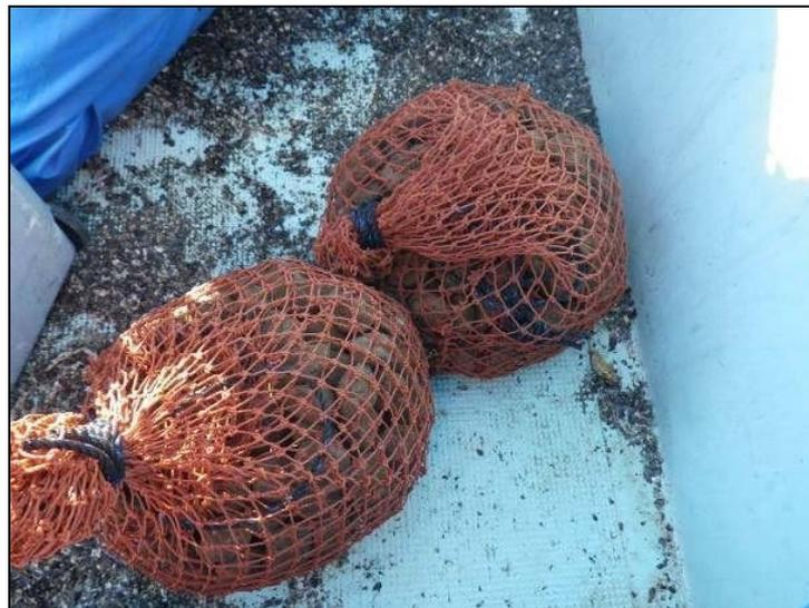
図 3-2 実証試験に使用したスラグ造粒物(写真は1袋あたり7kg)
