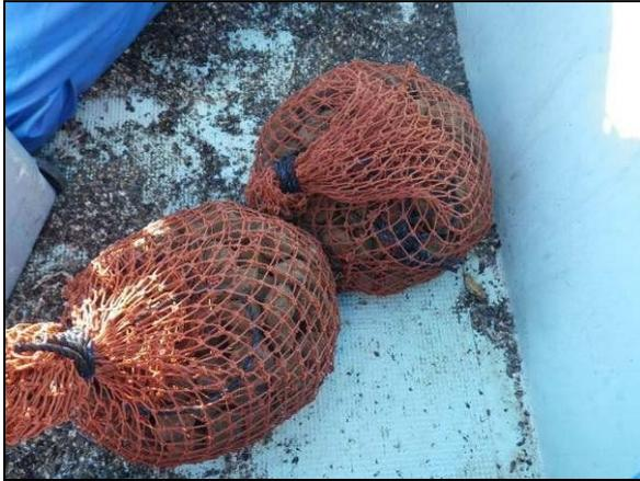
図1 試験に用いたスラグ造粒物(7kg)
