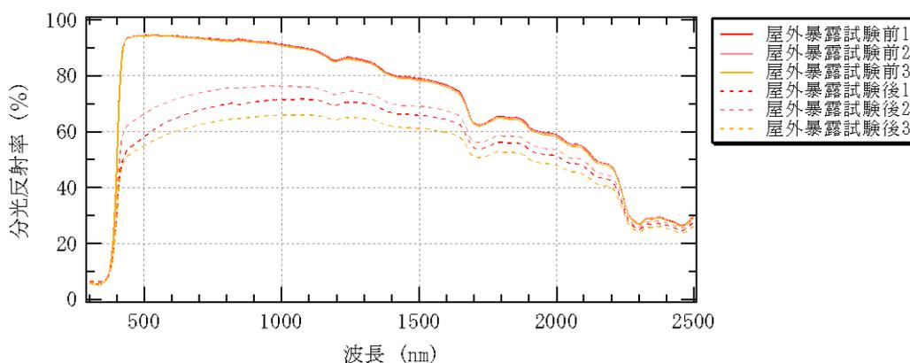
図-4 分光反射率測定結果 (白)
