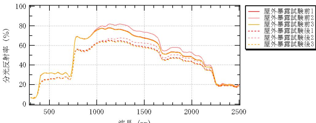
図-3 分光反射率測定結果(N6)
