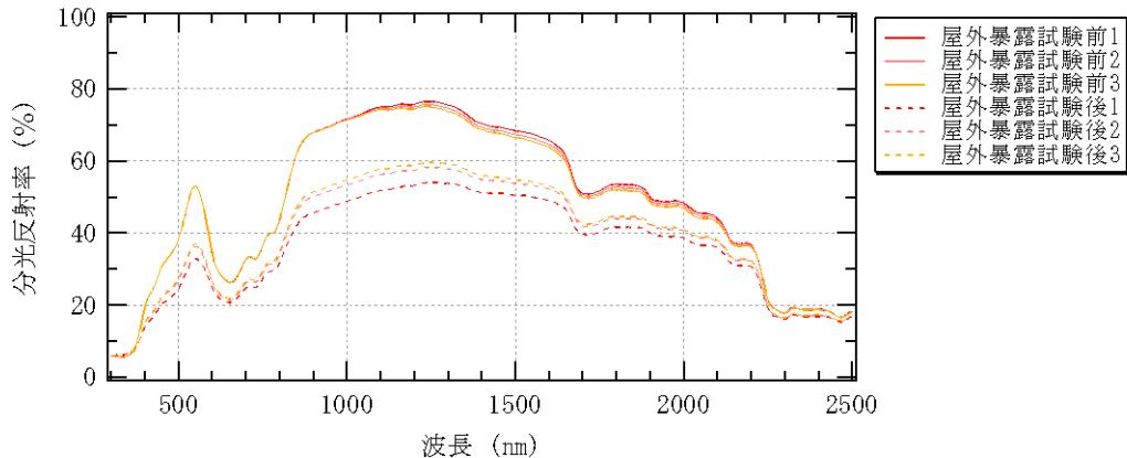
図 5-2 分光反射率測定結果（ライトグリーン）
