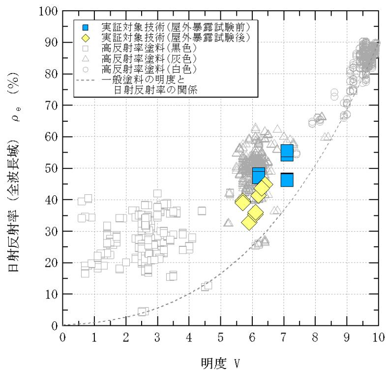
図 5-1 明度と日射反射率(全波長域)の関係
