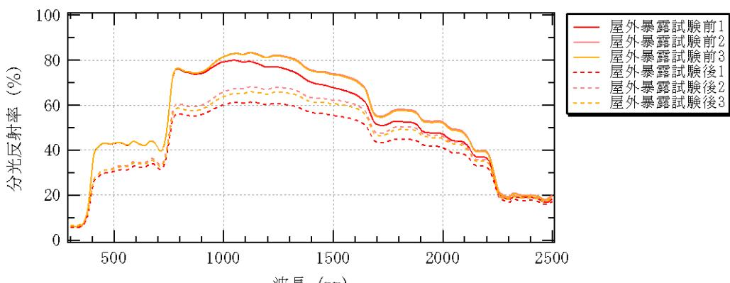
図-4 分光反射率測定結果(ライトグレー)
