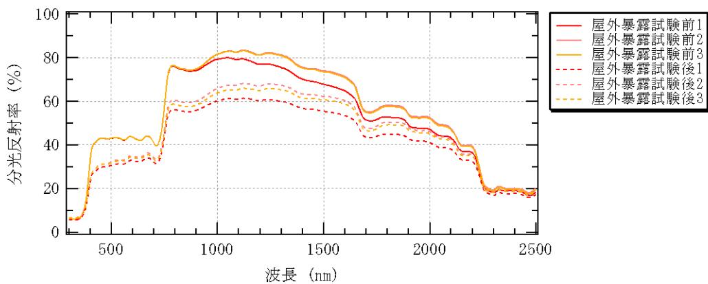
図 5-4 分光反射率測定結果（ライトグレー）
