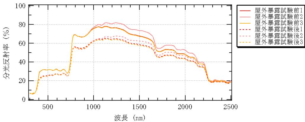
図 5-3 分光反射率測定結果（N6）
