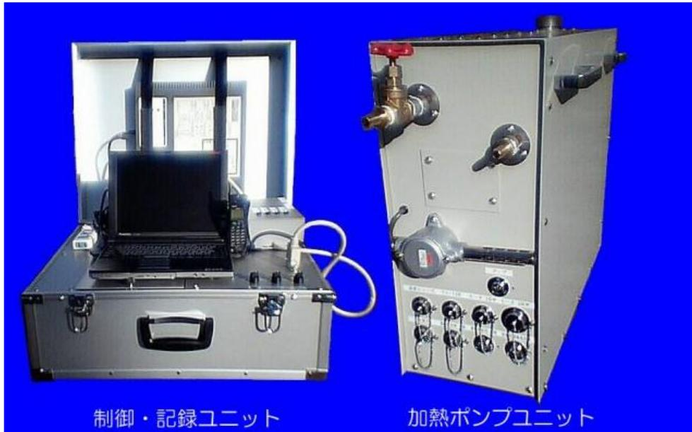
写真1 制御・記録ユニット、加熱・ポンプユニット装置写真
