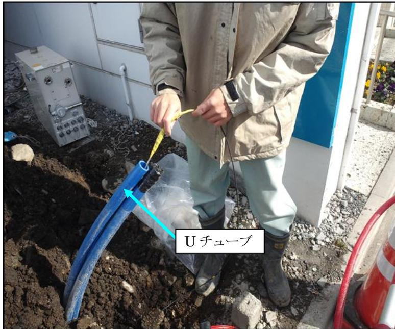
写真2 測温抵抗体による初期温度測定
