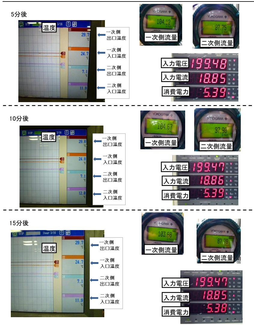
図 6-3 計測器の指示の写真（冷房期間の温度条件 2）
