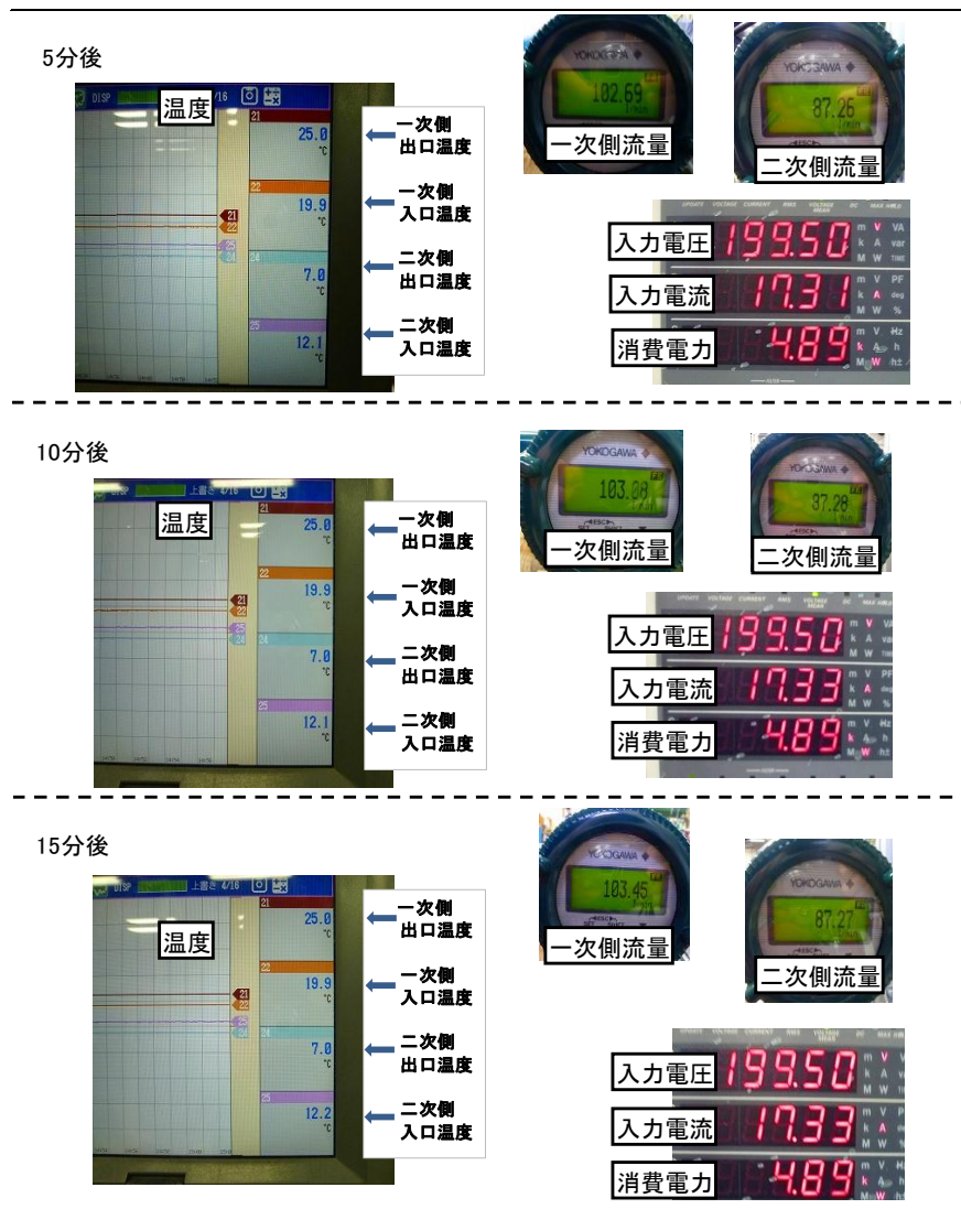
図 6-1 計測器の指示の写真 (冷房期間の温度条件 1)
