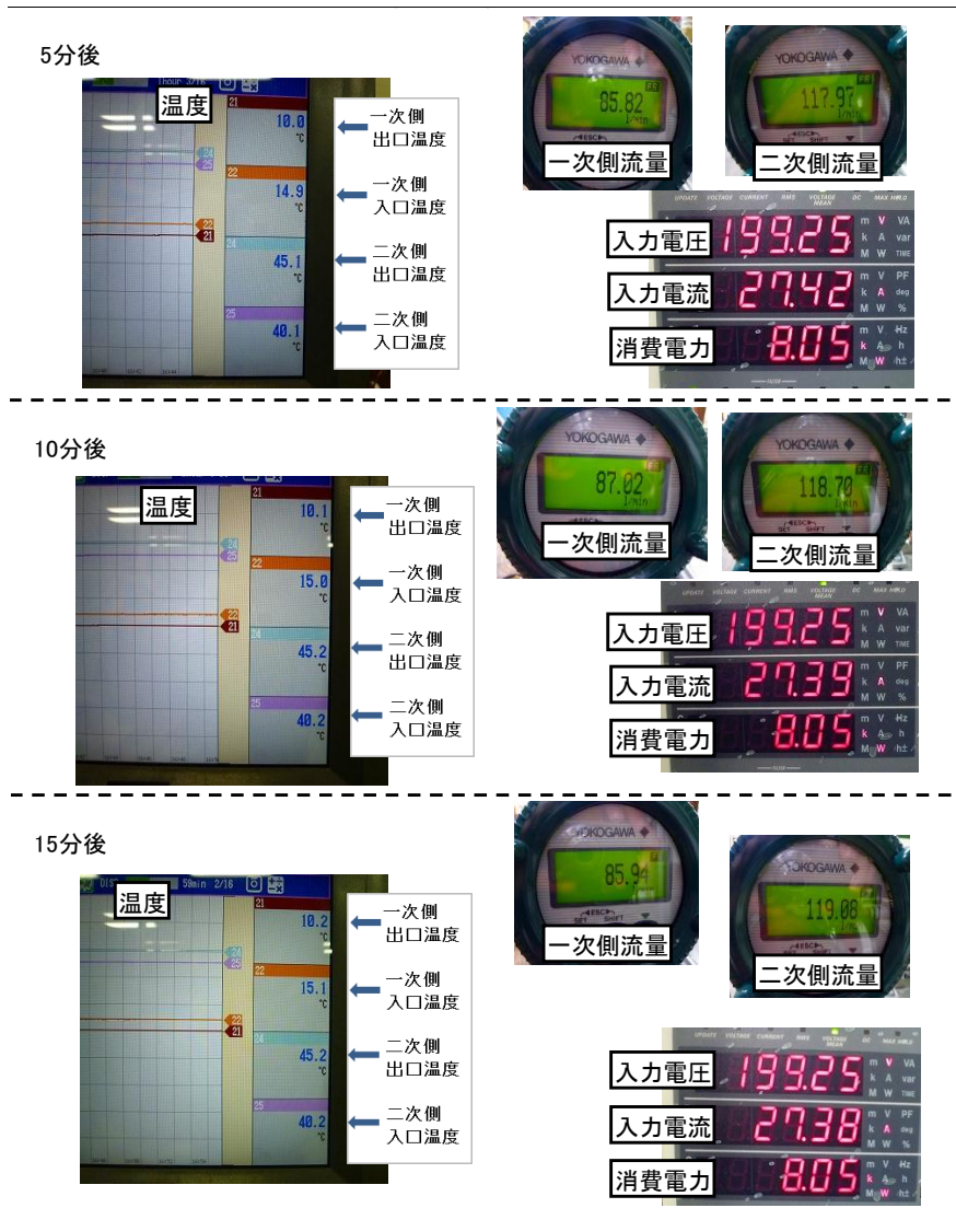
図 6-7 計測器の指示の写真（暖房期間の温度条件 1）
