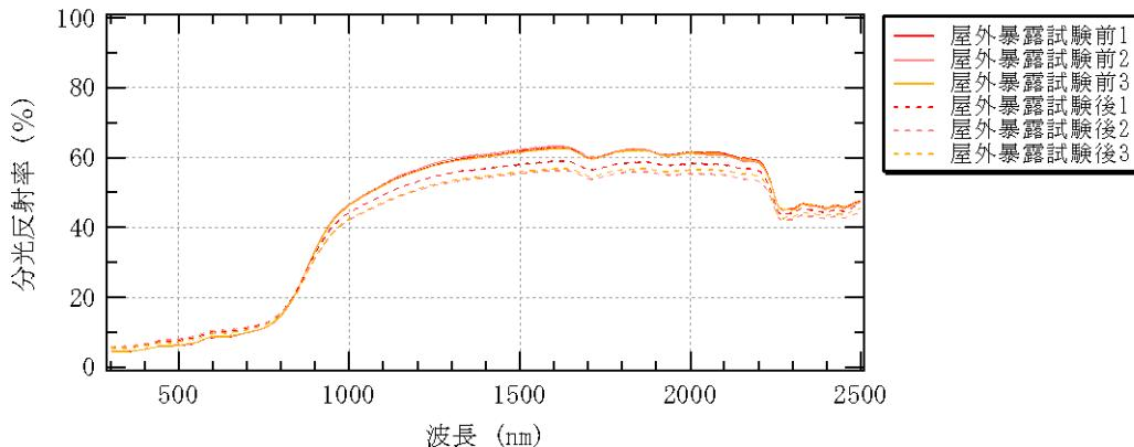
図 5-2 分光反射率測定結果（黒色）
