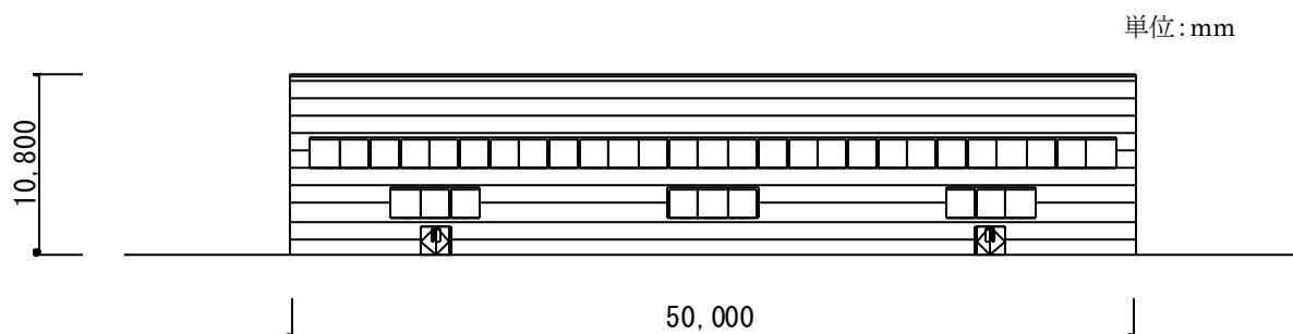
付図 1 計算用工場モデル (南側立面図)
