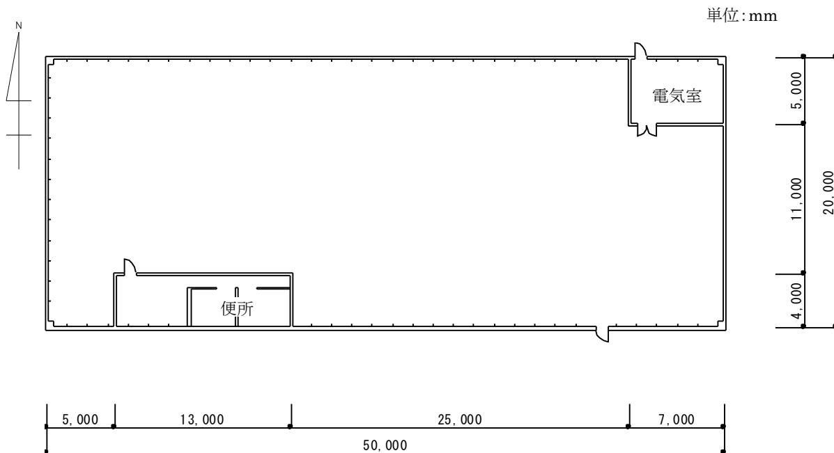
図 4-1 計算用工場モデル（平面図）
