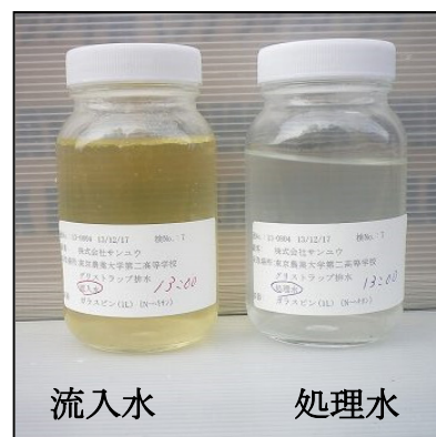
図 6-3 流入水、処理水の外観
