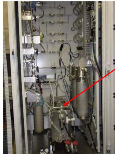
試験用ガス調製装置
