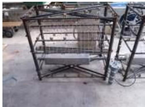
実験フローと微弱電流によるサンゴの成長促進装置
