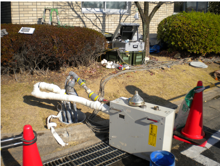
写真３ 配管の保温後の接続状況、試験装置の制御装置は奥の方に設置している。
