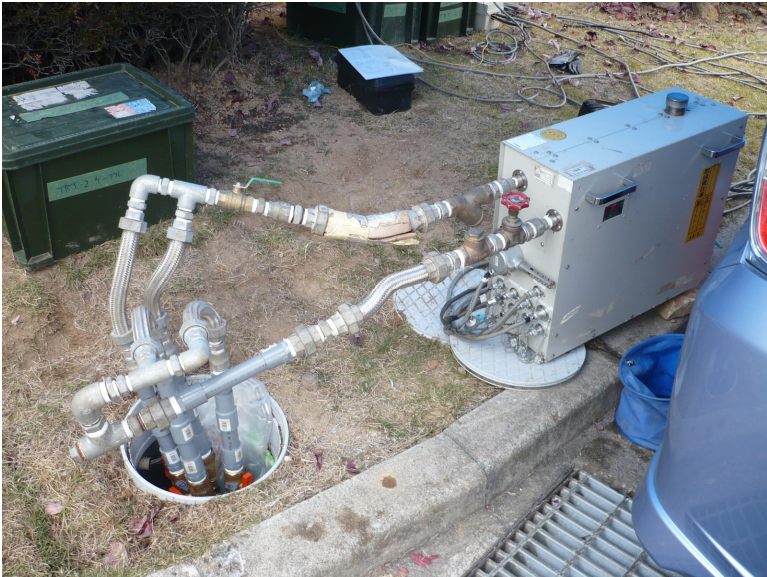
写真２ ダブルU字管や配管と試験装置の保温前の接続状況
