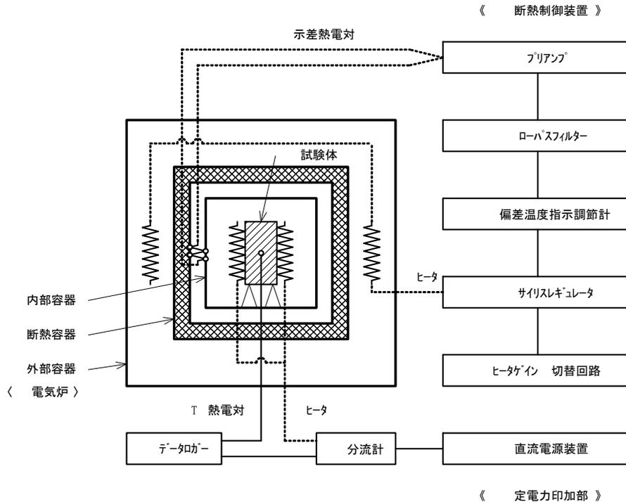
図 4-5 断熱熱量計比熱測定装置概要
