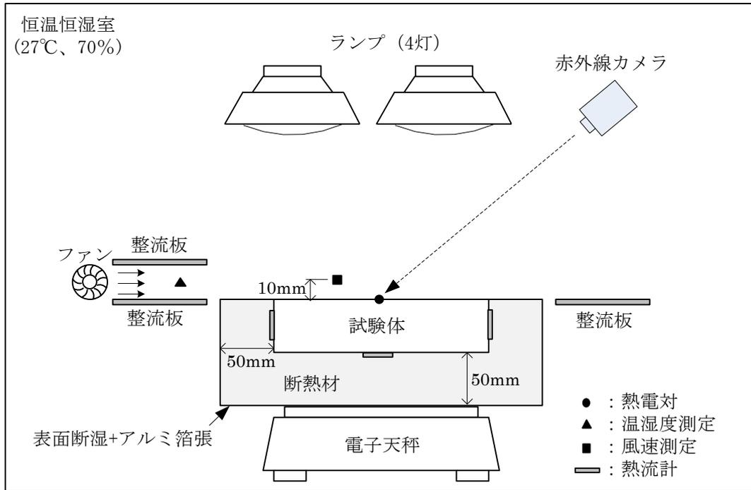
図 4-3 蒸発性試験の概要
