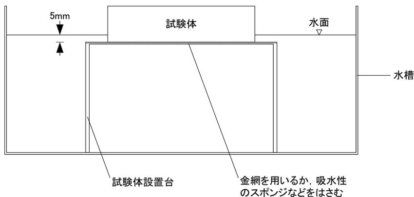
図 4-2 吸水性試験装置の概略\*1
