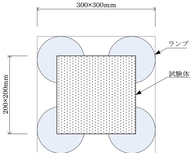
図 4-4 ランプと試験体の位置
