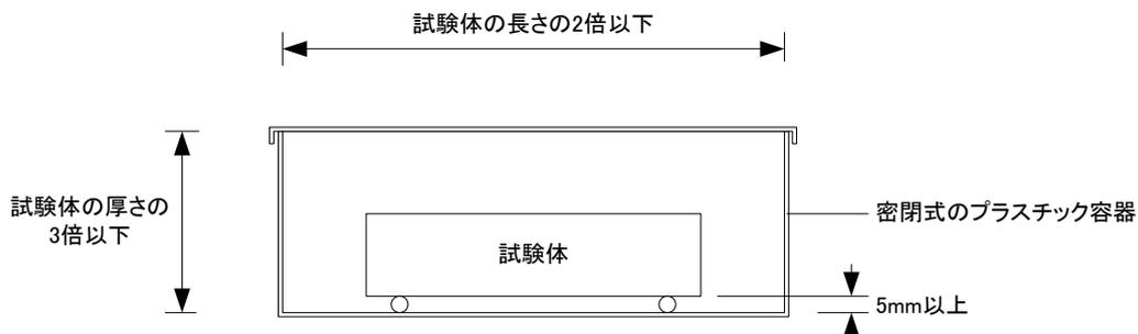
図 4-1 湿潤状態にする装置の概略\*1
