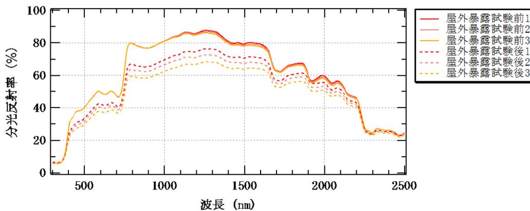
図 5-3 分光反射率測定結果 (遮熱ベージュ)
