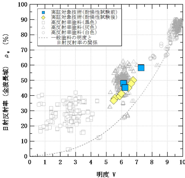
※左図は、平成 20 年度～平成 24 年度環境技術実証事業ヒートアイランド対策技術分野(建築物外皮による空調負荷低減等技術)において実証を行った高反射率塗料(高反射率防水仕上塗料を含む)と一般塗料の明度と日射反射率(全波長域)の関係を示したものである。
