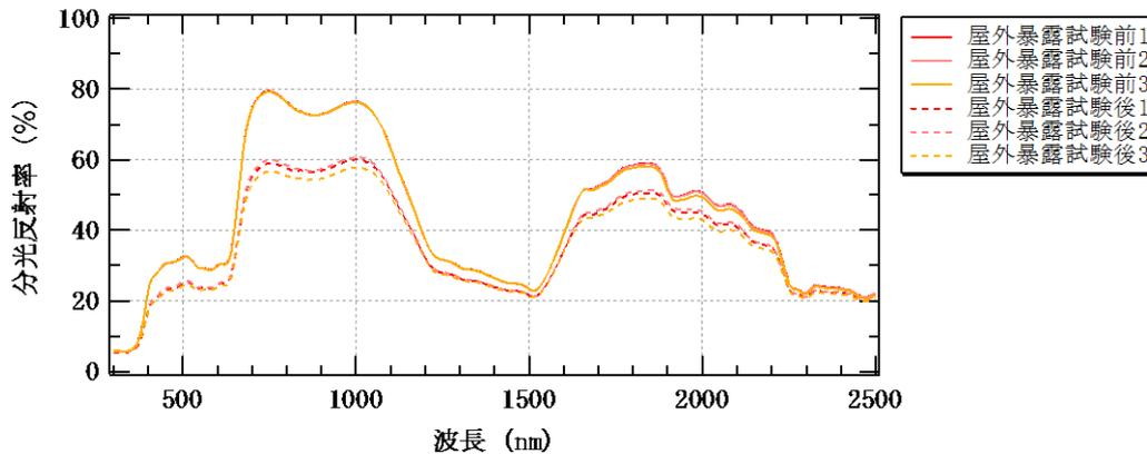
図 5-2 分光反射率測定結果 (遮熱グレー(N6))
