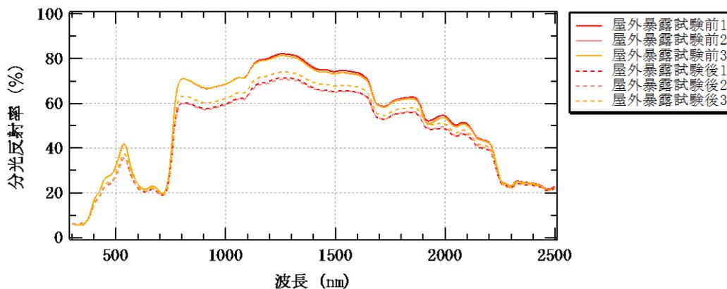
図 5-4 分光反射率測定結果 (遮熱グリーン)
