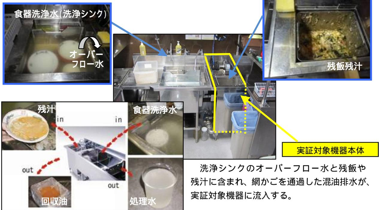
図 3 - 2 実証試験実施箇所の実証対象技術の機器構成
