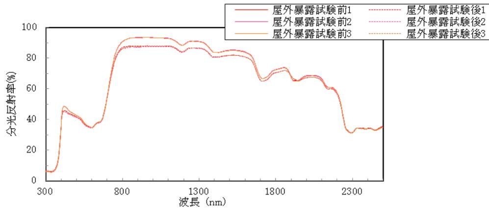
図-2 分光反射率測定結果（灰色）
