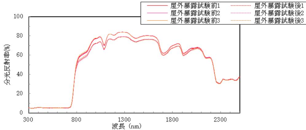
図-2 分光反射率測定結果 (黒色)
