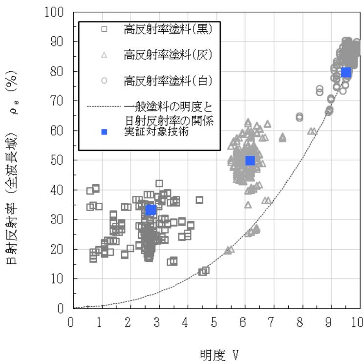
※左図は、平成 20 年度～平成 23 年度環境技術実証事業ヒートアイランド対策技術分野（建築物外皮による空調負荷低減等技術）において実証を行った高反射率塗料と一般塗料の明度と日射反射率（全波長域）の関係を示したものである。
