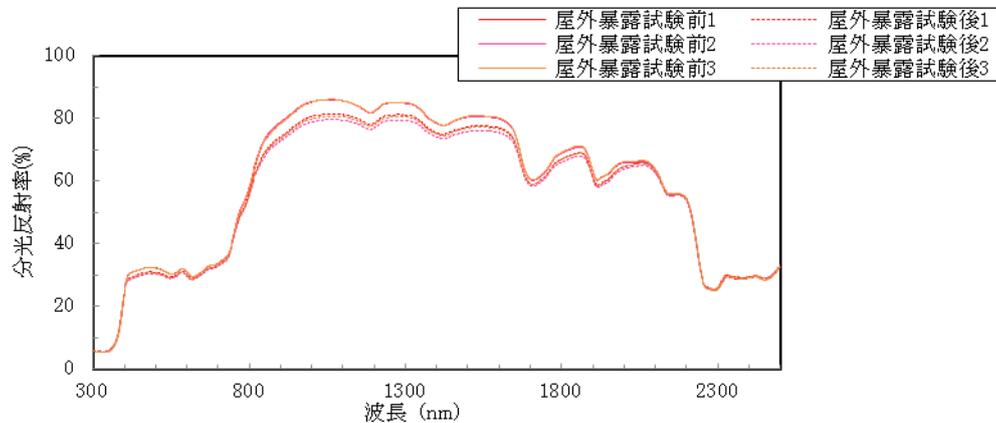
図-3 分光反射率測定結果 (灰色)
