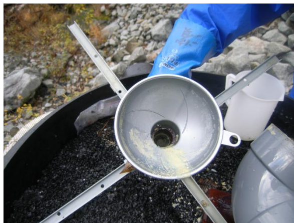
写真 6-2-4-2 分散装置の目詰まり 2
