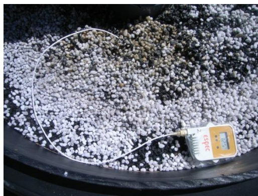
写真 5-4-1-6 特殊枡の温度 (温度センサーの設置状況)
