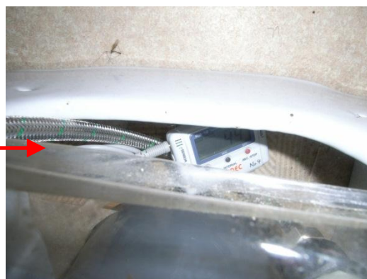
写真 5-4-1-5 トイレブースの室温・湿度 (温湿度センサーの設置状況)
