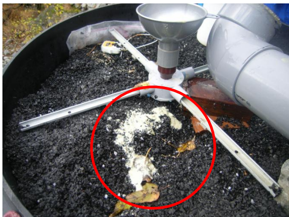
写真 6-2-4-3 分散装置の沈着物
