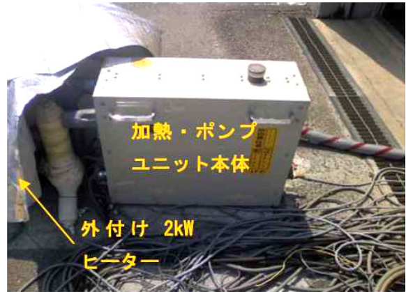
加熱・ポンプユニットの写真
