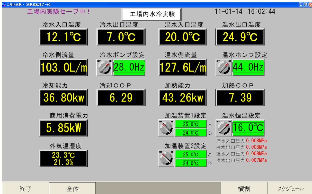
図 6-2 測定画面のコピー (測定 1 回目)
