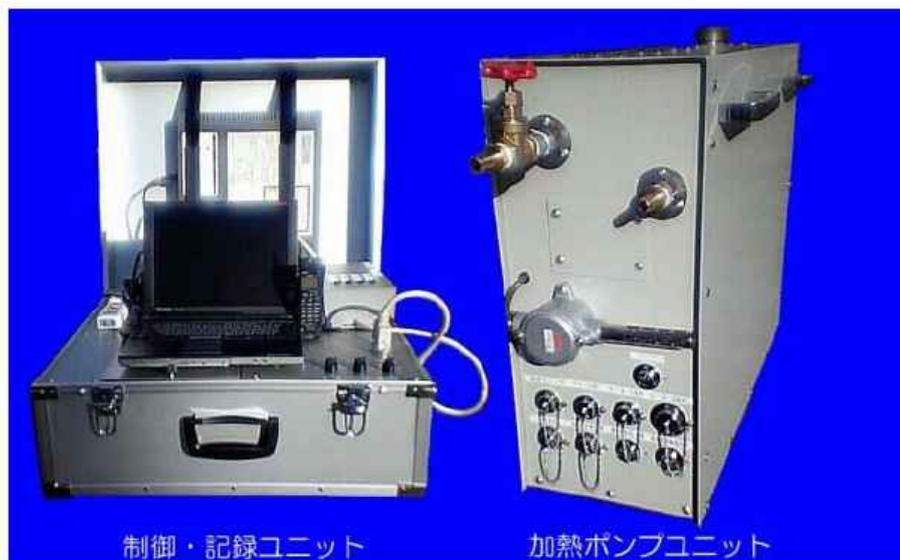
写真 4-5-5 制御・記録ユニット、加熱・ポンプユニット装置写真
