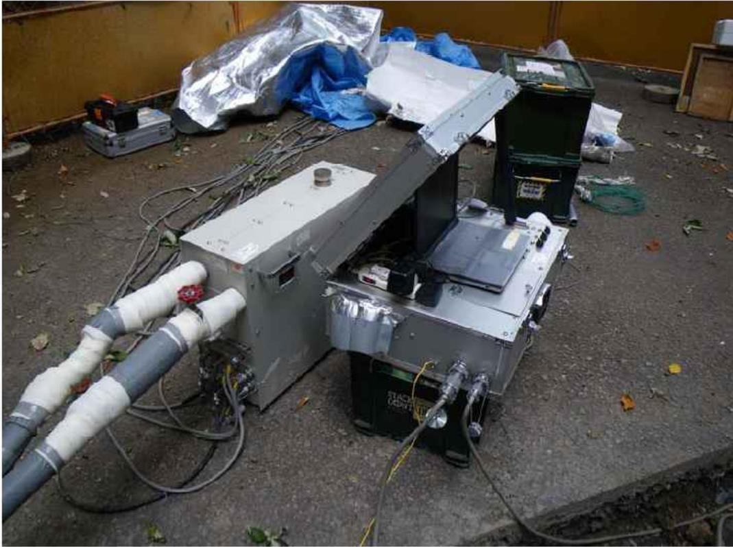
写真 4-5-8 熱応答試験装置（加熱・ポンプユニット）
