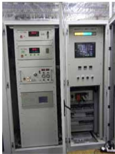
試験用ガス調製装置
