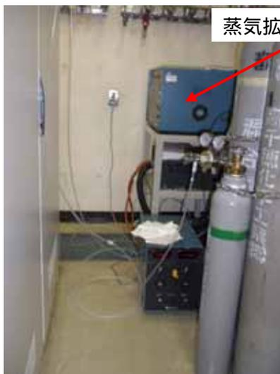
蒸気拡散管用恒温槽
