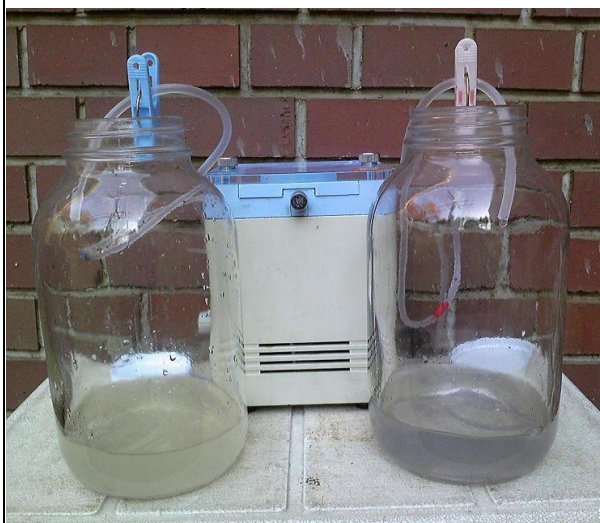
(7)ペリスタポンプによる採水 左:グリストラップへの流入水 右:グリストラップからの流出水 (厨房業務中、ばっ気前)
