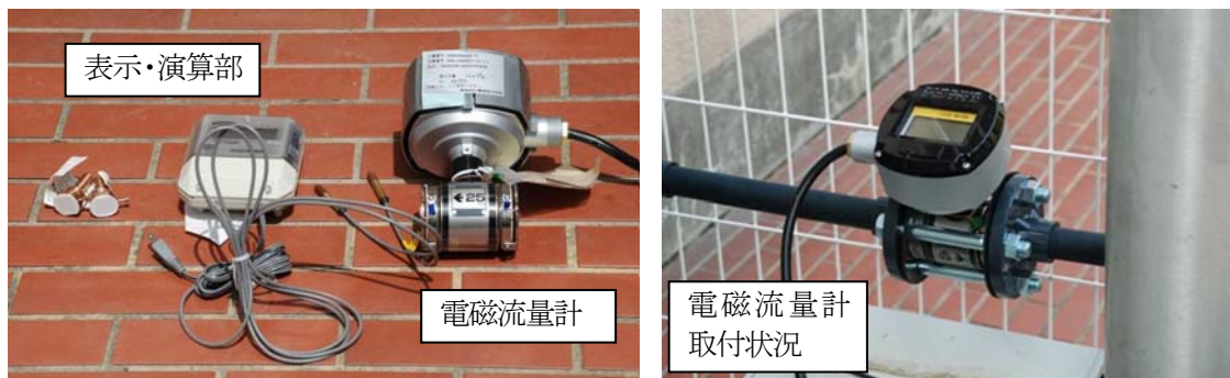
図 4-7 積算熱量計（電磁流量計、温度計、表示・演算部よりなる）
