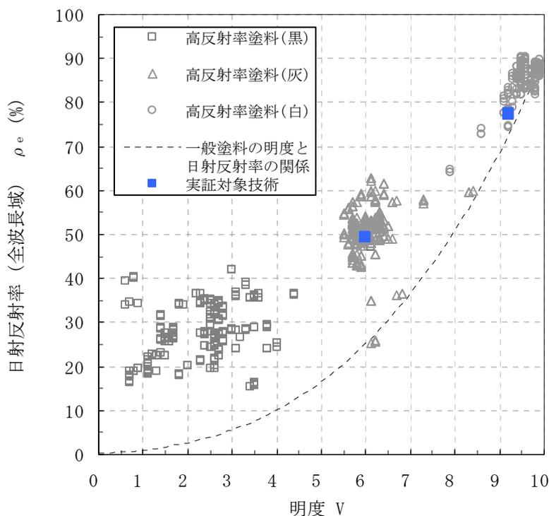
※左図は、平成 20 年度及び平成 21 年度環境技術実証事業ヒートアイランド対策技術分野（建築物外皮による空調負荷低減等技術）において実証を行った高反射率塗料と一般塗料の明度と日射反射率（全波長域）の関係を示したものである。
