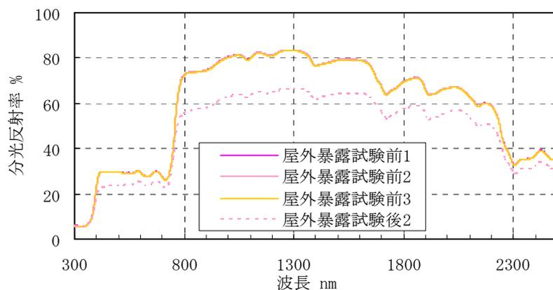
図-2 分光反射率測定結果（灰色）
