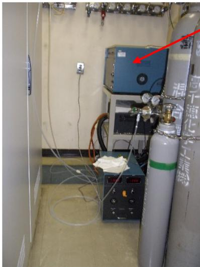
蒸気拡散管用恒温槽
