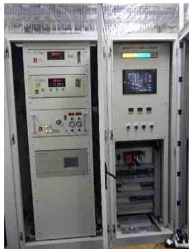
試験用ガス調製装置
