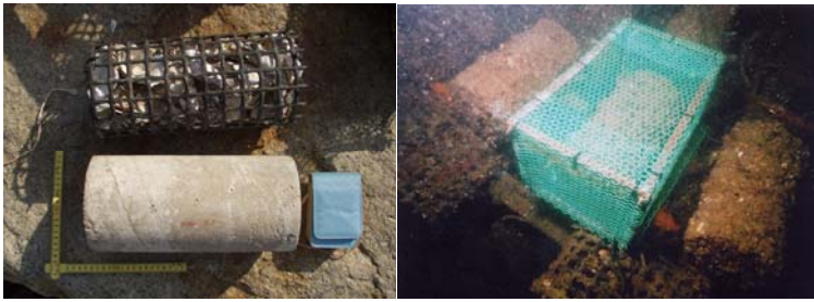
図5 テストピース(TP)の概観(左写真上:貝殻 TP(STP)、左写真下:コンクリート TP(CTP)、右写真:魚類補食防食用 TP(NTP))
