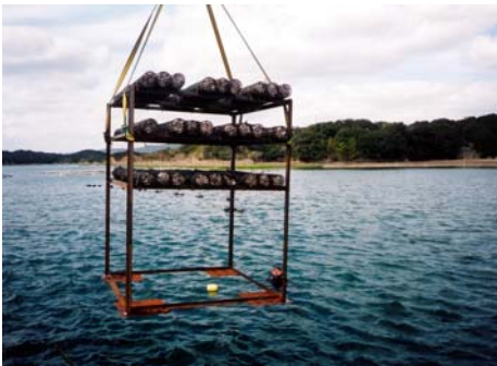
図5 テストピース(TP)の概観(左写真上:貝殻 TP(STP)、左写真下:コンクリート TP(CTP)、右写真:魚類補食防食用 TP(NTP))
