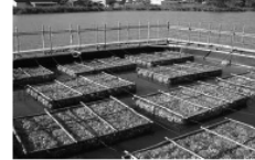
図-2 隔離水塊に設置した処理装置浮島
