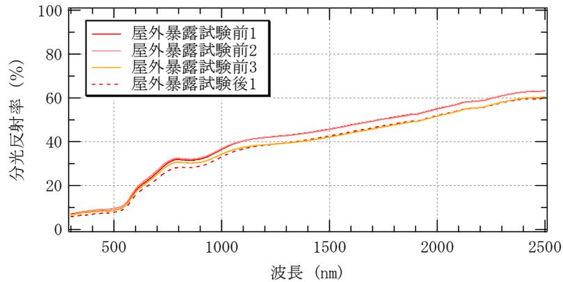
図5-2 分光反射率測定結果（ダーク）
