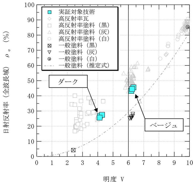
※左図は、平成20年度環境技術実証事業ヒートアイランド対策技術（建築物外皮による空調負荷低減等技術）において実証を行った高反射率建材の明度と日射反射率（全波長域）の関係を示したものである。
