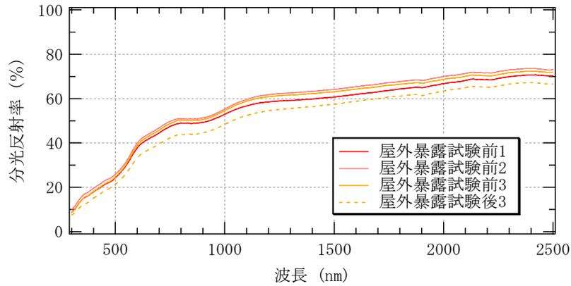
図-2 分光反射率測定結果 (ベージュ)
