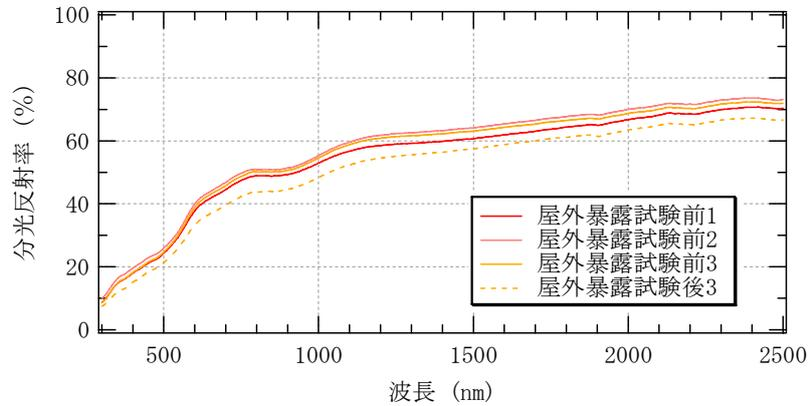
図5-1 分光反射率測定結果（ベージュ）
