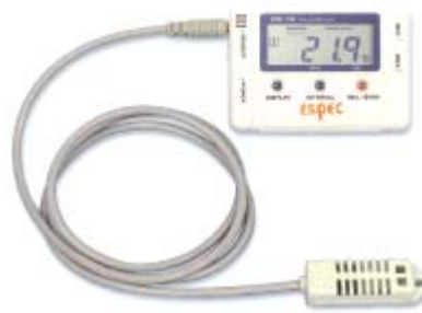
図5-4-1-1 温湿度センサーの外観
