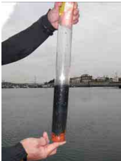
図 5 - 2 4 底質による酸素消費速度測定の様相(写真)
