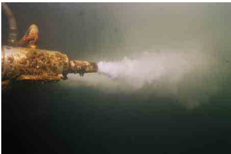
図5 - 2 5 ノズルから噴射される微細気泡の状況(写真)
