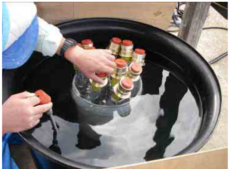
図 5 - 2 4 底質による酸素消費速度測定の様相(写真)
