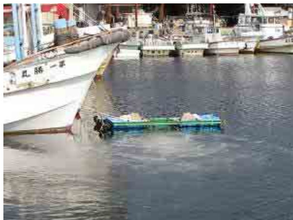
装置1設置状況(浮体吊り下げ式)
