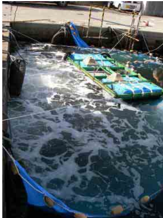
図5 - 29 装置の酸素供給能力調査の状況(写真)
