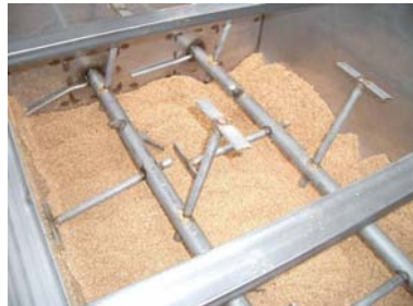
杉チップ 攪拌槽内部
