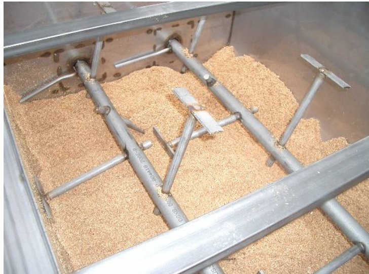
図 4-2 杉チップ攪拌槽内部
