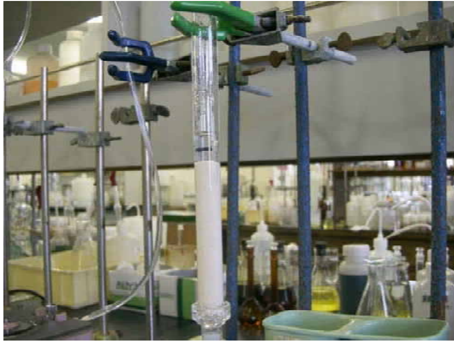
樹脂からのほう素溶出作業
